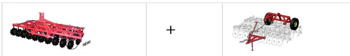
**Борона дисковая полунавесная (универсальная)** предназначена для традиционной и минимальной основной и предпосевной обработки почвы под зерновые, технические и кормовые культуры, освежения задерненных лугов и лущения стерни с твердостью почвы до 4,5 МПа при влажности до 30%. За один проход борона производит измельчение и заделку растительных остатков предшественника и сорной растительности в почву, создает взрыхленный и выровненный слой почвы, заделывает внесенные удобрения.
