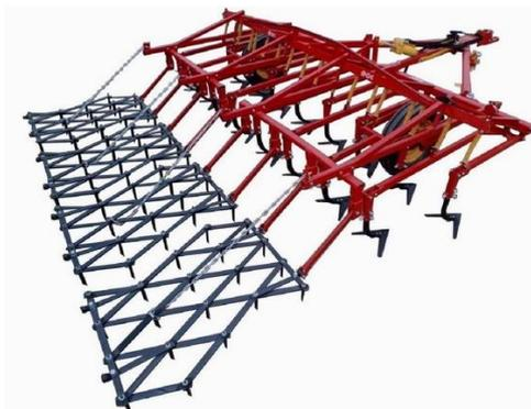
Культиватор **КПС-4Г** предназначен для предпосевной обработки почвы и обработки паров с одновременным боронованием.
