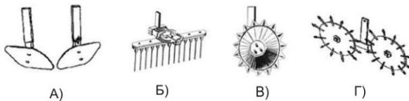
Культиватор имеет оригинальные секции рабочих органов с групповой бесступенчатой регулировкой глубины обработки. В параллелограммном механизме применены подшипники, что значительно повышает надёжность механизма и позволяет до минимума сократить величину защитной зоны при обработке.
