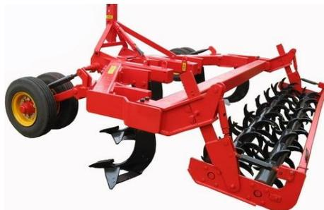
Глубокорыхлитель ГЦ-4М "Евро" предназначен для глубокого рыхления почвы на глубину до 50 см с целью гарантированного разрушения "плужной подошвы" и разуплотнения почв. Оборудуется системой защиты стоек от перегрузок - срезной болт. Рабочие органы - нож (наральник) шириной 75 мм, крылья левое и правое шириной захвата 300 мм.
